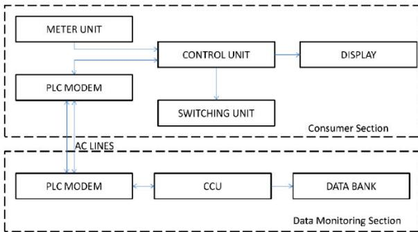
Fig. 6. Block Diagram of PLCC smart Electricity Meter
